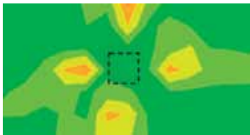
Thermografisch beeld in verwarming bij een cassette zonder golvende werking.
