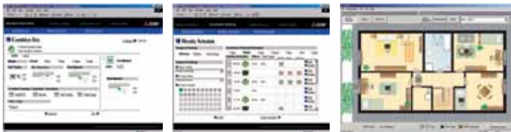
Overzichtelijke, goed leesbare beeldschermen visualiseren de installatie in een oogwenk. Het is bovendien mogelijk een plan in te scannen en dit als achtergrond te gebruiken.
